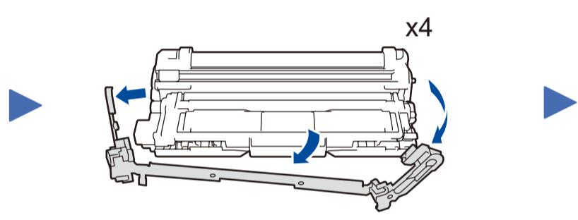
紧紧地推入到位 (注意将耗材颜色与指示严格对应)。
