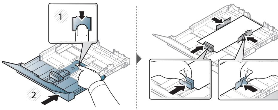
如果纸张长度超过 A4 (如 Legal), 按下并打开纸盘中的导板锁, 手动拉出纸盘。然后调整纸张长度导板和纸张宽度导板。
