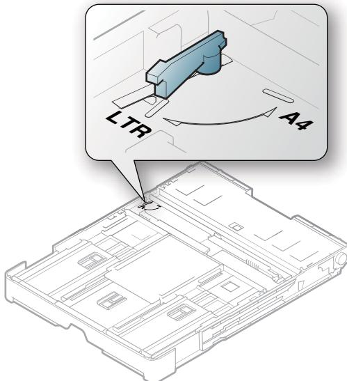
3 捏住纸张宽度导杆，将其滑动到控制杆边缘。
