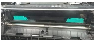
6. 将导纸板金卡榫以逆时钟方向往下扳，使导纸板金恢复成原来的状态。
