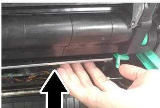
3. 移除显影组件的包装材料、及保护装置
