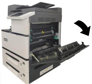
2. 将导纸板金卡榫以顺时钟的方向扳开①，再往上推②，固定导纸板金。
