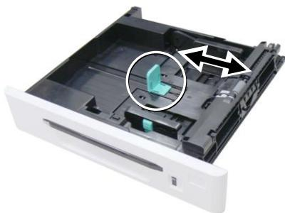
6. 放入纸张，并将纸张的**待打印面朝上**，A4纸请如图长边进纸放置。
