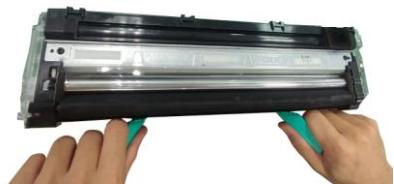
5. 双手握住把手，将显影组件的前端**先朝下**①碰触到两边轨道的上方，再沿着轨道将显影组件平行推入机台内②。确定把手平放在显影组件的表面③。
