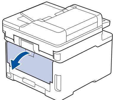
3. 朝您所在方向拉动左右两侧的绿色滑块，以松开定影单元盖。
