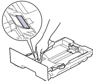
5. 擦去设备内部两个摄纸辊上的灰尘。
