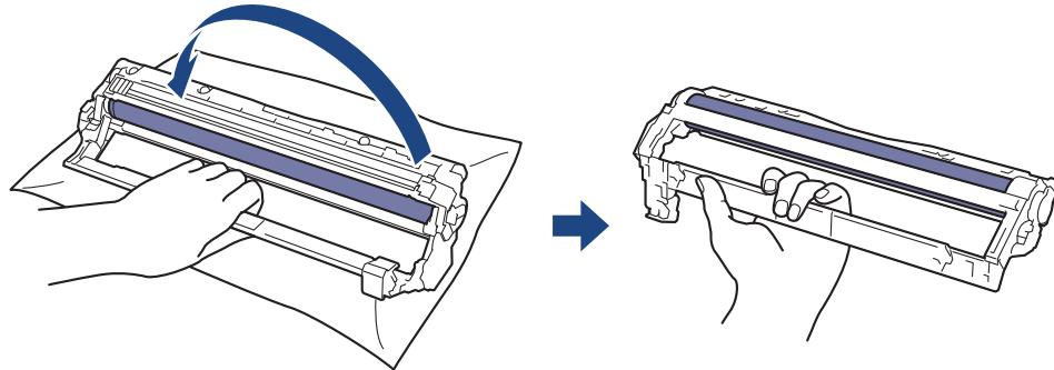
9. 松开手使边框向前落下，然后用右手将硒鼓单元齿轮定位在边框右侧。
