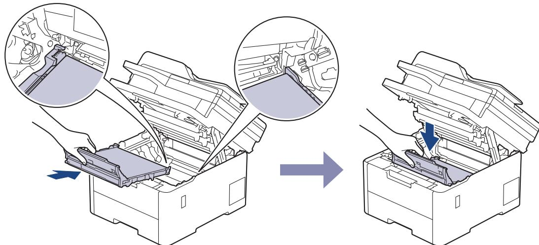
9. 将各墨粉盒和硒鼓单元组件插回设备。确保所有四个墨粉盒和硒鼓单元组件的墨粉盒颜色与设备上的颜色标签相匹配。
