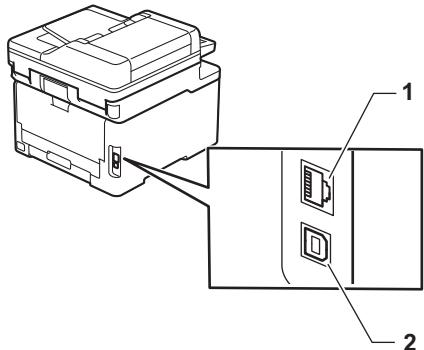
1. 10BASE-T/100BASE-TX/1000BASE-T 端口 (适用于有线网络型号)
