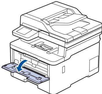
3. 用双手滑动单张进纸托板的纸张导块，调整至所用纸张的宽度。
