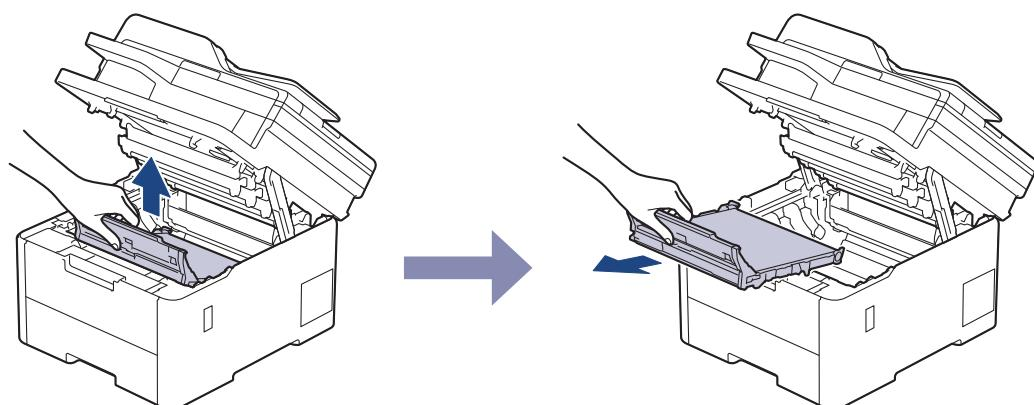
5. 拆开新转印带单元的包装，然后将其插入设备内。
