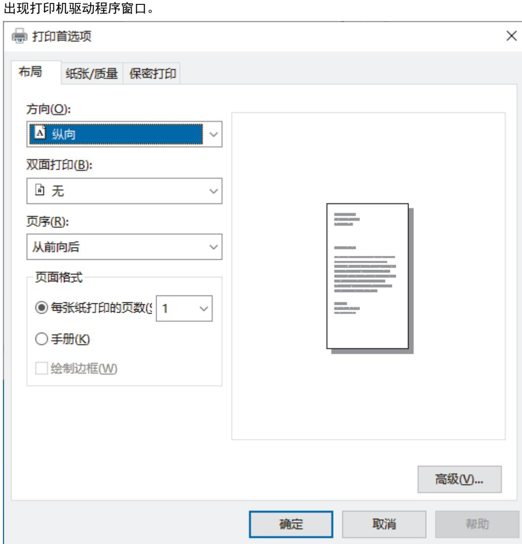
3. 点击**布局**、**纸张/质量**或**保密打印**选项卡更改基本打印设置。（适用于特定型号）
