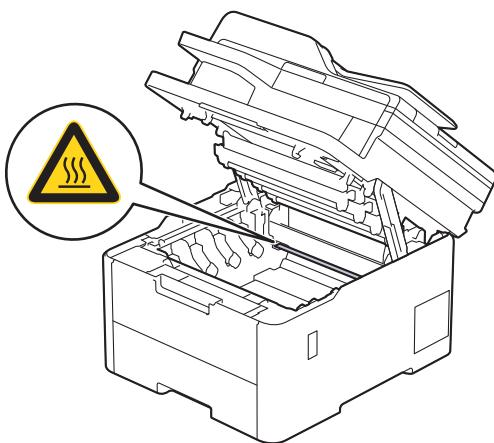
6. 硒鼓点阵检查表上所打印斑点的颜色即为应清洁的硒鼓的颜色。取出导致问题的颜色所对应的墨粉盒和硒鼓单元组件。
