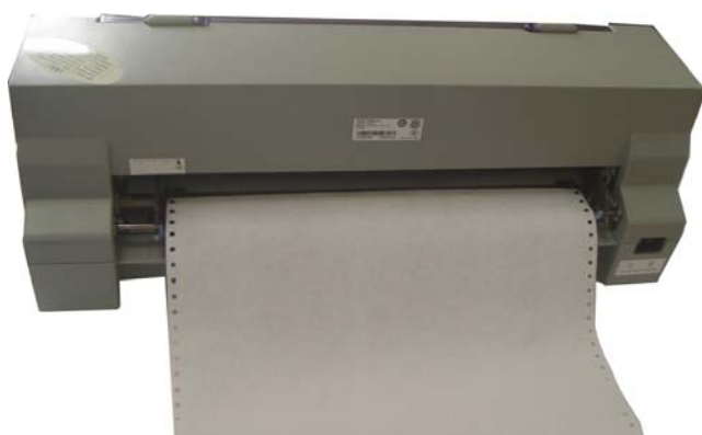
图 3-12 将连续纸安装在拖纸器链轮上
