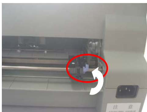
图 3-9 松开链轮锁定杆
